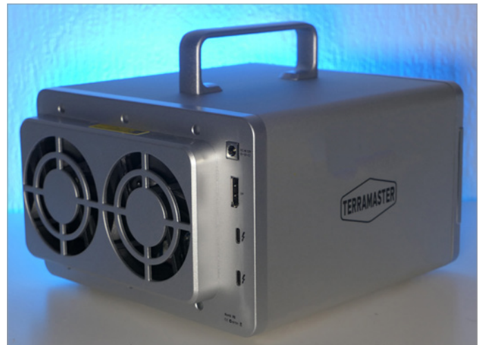
Mit zwei Thunderbolt-3-Anschlüssen lassen sich weitere Thunderbolt-Geräte hinter dem Gerät betreiben.
