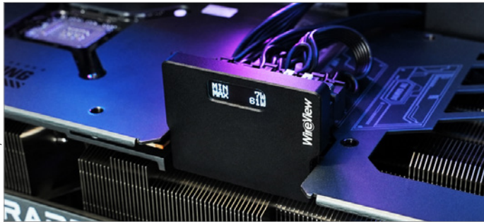
Das nützliche Strommessgerät für Grafikkarten „Wireview“, von ElmorLabs und Thermal Grizzly entwickelt und von letzteren vertrieben, spielte unverschuldet eine Rolle beim Ausfall der ersten Test-XTX.
