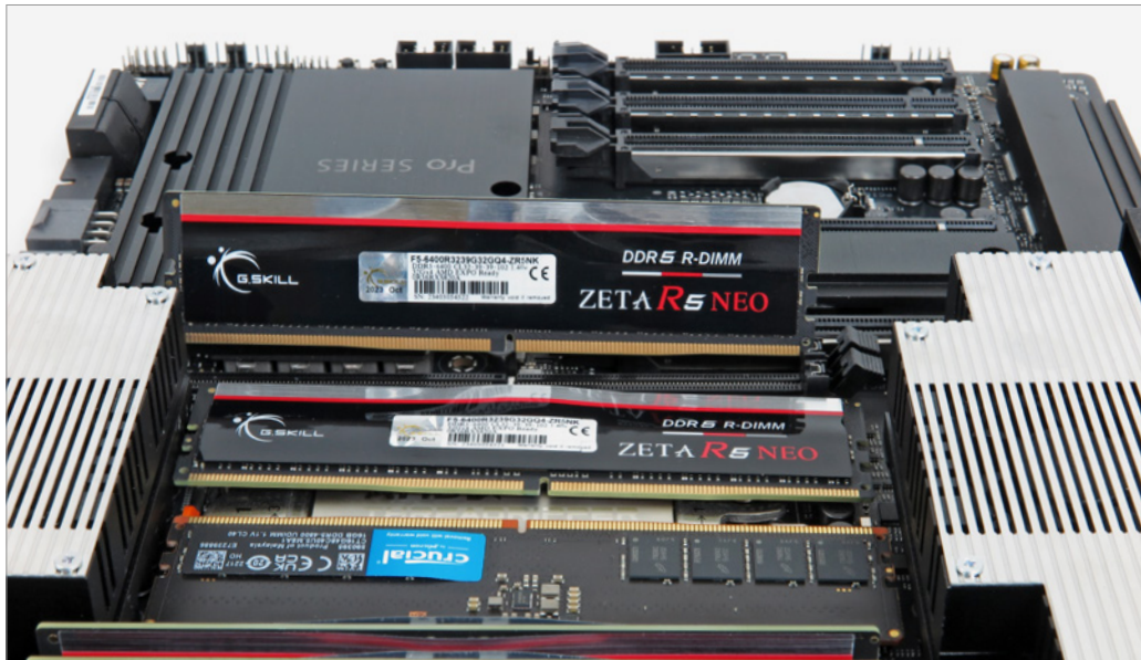
Passt nicht und soll es auch nicht: Normaler DDR5-Speicher (Crucial im Vordergrund als Beispiel) ist weder mechanisch noch elektrisch mit dem in aktuellen Workstations und Servern genutzten RDIMM-Format kompatibel.
