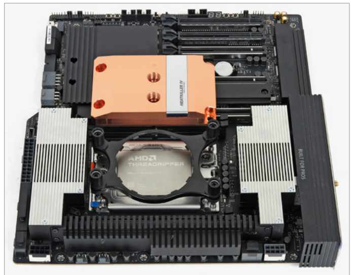
Montageposition unverändert: Prinzipiell passen TR4-Kühler auf TR5-Mainboards und AMD selbst legt unveränderte Halterahmen für Asetek-KoWaKüs bei.
