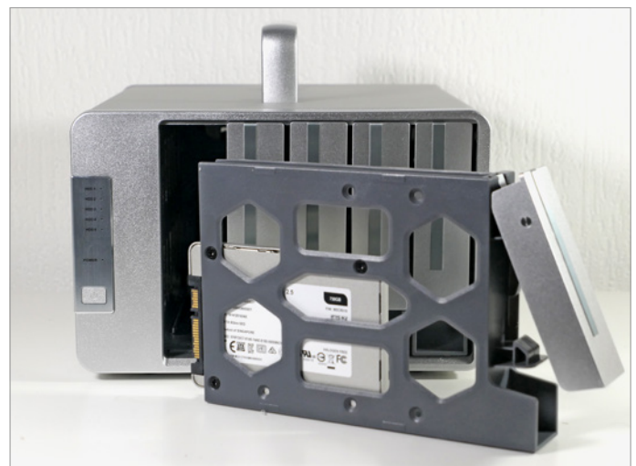
Die Einschübe sind vergleichbar mit denen eines NAS und ebenso flexibel, wenn auch nicht im Betrieb austauschbar.
