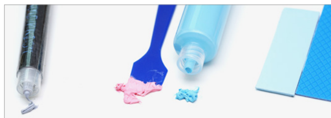
Zwischen der niedrigviskosen Paste und den Pads liegt das Thermal Putty. Es überbrückt größere Distanzen ohne zu verlaufen, bietet aber im Vergleich zu den festen Pads eine hohe Nachgiebigkeit.
