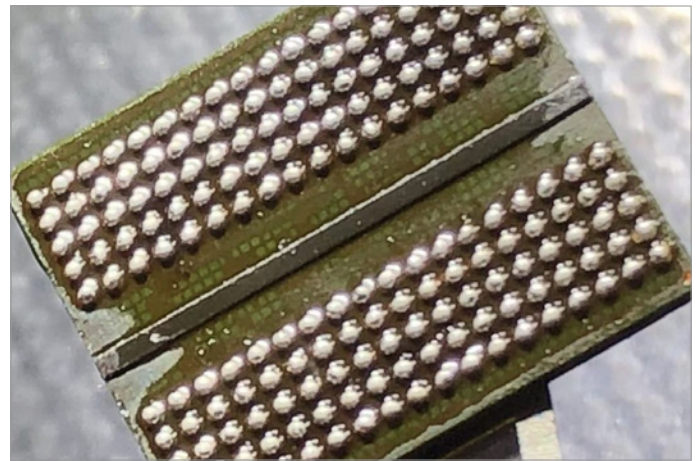
Lötperlen an der Unterseite eines 7900-XTX-Speicher-Chips, wiederhergestellt nach dem „Reballing“.
