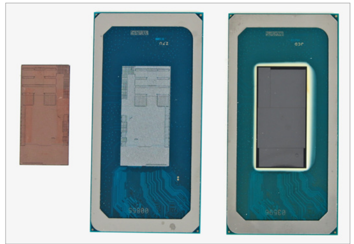
Auf dem MTL-Substrat (Mitte) sitzt ein Base-Tile (Rückseite links), darauf Graphics-, SoC-, I/O- & Compute-Tile. Letztere sind in allen Folien spiegelverkehrt dargestellt.
