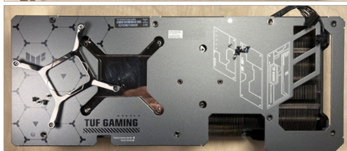
Demontage der Asus TUF Gaming Radeon RX 7900 XTX OC: Alle Schrauben auf der Backplate-Seite werden entfernt. Lüfter- und RGB-Stecker nicht vergessen!
